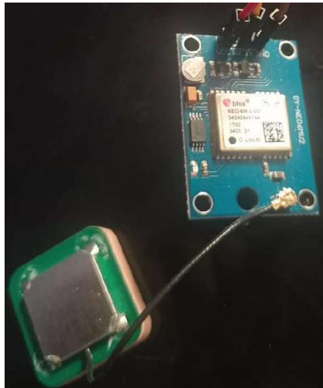
Figure 3-14 UBLOX NEO-6M V2 GPS-MODUL
