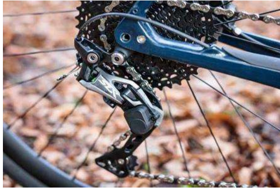
Figure 3-22: Sprockets and Rear derailleur
